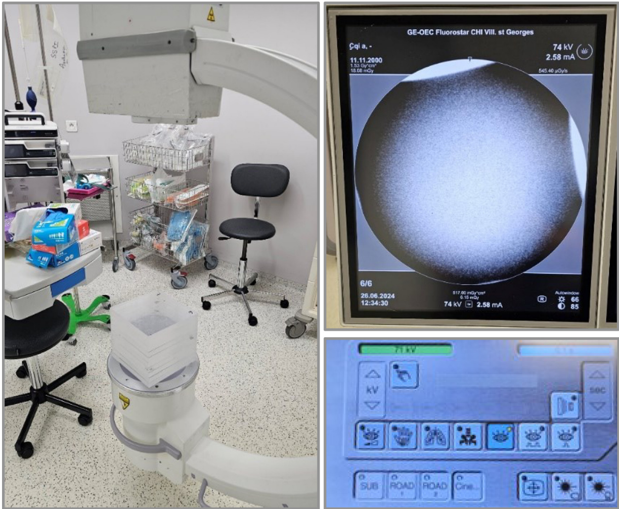
FIGURE 2 Réalisation d'un CQI trimestriel (a) arceau avec les plaques de PMMA (b) écran de contrôle (c) panneau de commande
